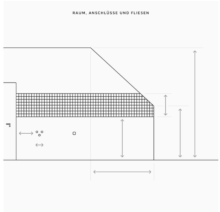
Zu messen: Raumhöhe, eventuelle Dachschrägenhöhe, Abstand von Fliesen zu Boden und Fliesenhöhe. Einzeichnen von Herdanschluss, Wasseranschluss und Abstände zu anderen Objekten.
