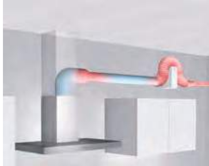
Příklad špatného odtahového potrubí
