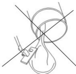
5. Verwenden Sie das Gerät nicht zum Aufsaugen von Nadeln, Reißnägeln oder Schnüren sowie von Zement, Gips oder anderen Baumaterialien.
