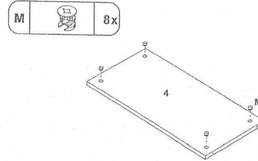
4: Türen vormontieren, *Prémontier la/les portes*, Deuren vormontieren
