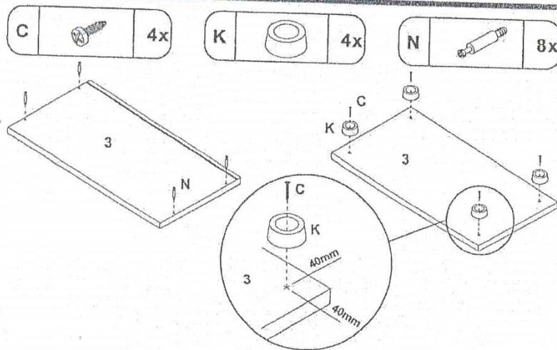
3: K-Boden vormontieren, *Prémontier le fond du corps*, K-Bodem vormontieren
