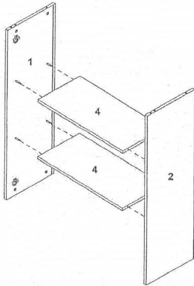
6: Korpus montieren, *Monter le corps*, Kast montieren
