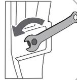
**1** Schieben Sie die Schläuche beiseite und verwenden Sie einen passenden Schraubenschlüssel, um die 4 Bolzen auf der Rückseite gegen den Uhrzeigersinn zu lösen, wie durch den Pfeil angezeigt. Lösen Sie sie um etwa 30 mm (nicht vollständig).
