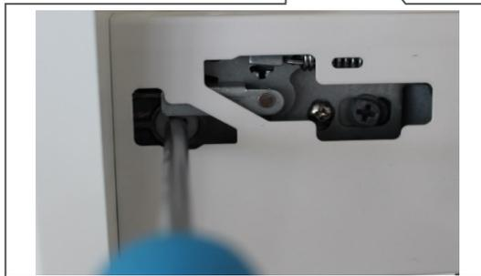
Mit Betätigung der vorderen Schraube wird die Fronteinstellung in horizontaler Richtung vorgenommen!
