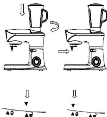
1. Setzen Sie den zusammengesetzten Behälter auf das Motorgehäuse, sodass der Pfeil auf den Kreis ausgerichtet ist. Drehen Sie ihn im Uhrzeigersinn, sodass der Pfeil auf den Pfeil ausgerichtet ist.
