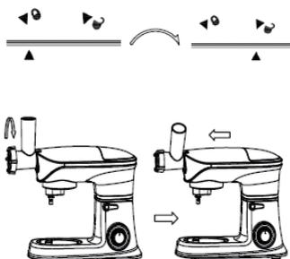
Um den Fleischwolf abzunehmen, drehen Sie das Gehäuse, sodass der Pfeil auf den Kreis ausgerichtet ist und entfernen Sie ihn dann.
