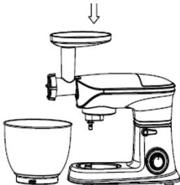
1. Setzen Sie die Fleischschale (9) auf das Fleischwolfgehäuse (8), sodass sich der längere Teil über dem Motorgehäuse des Geräts befindet.
