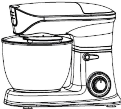
1. Senken Sie den Schwenkarm, bis dieser hörbar einrastet. Die Schüsselabdeckung (23) muss fest mit der Rührschüssel (27) verbunden sein. Sollte dies nicht der Fall sein, wurde die Abdeckung falsch aufgesetzt. Wenn sie korrekt aufgesetzt wurde, kann das Gerät nun verwendet werden.
