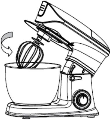
1. Befestigen Sie den Spritzschutz am Schwenkarm, wie auf der Abbildung ersichtlich. Stellen Sie sicher, dass er gut fixiert ist.
