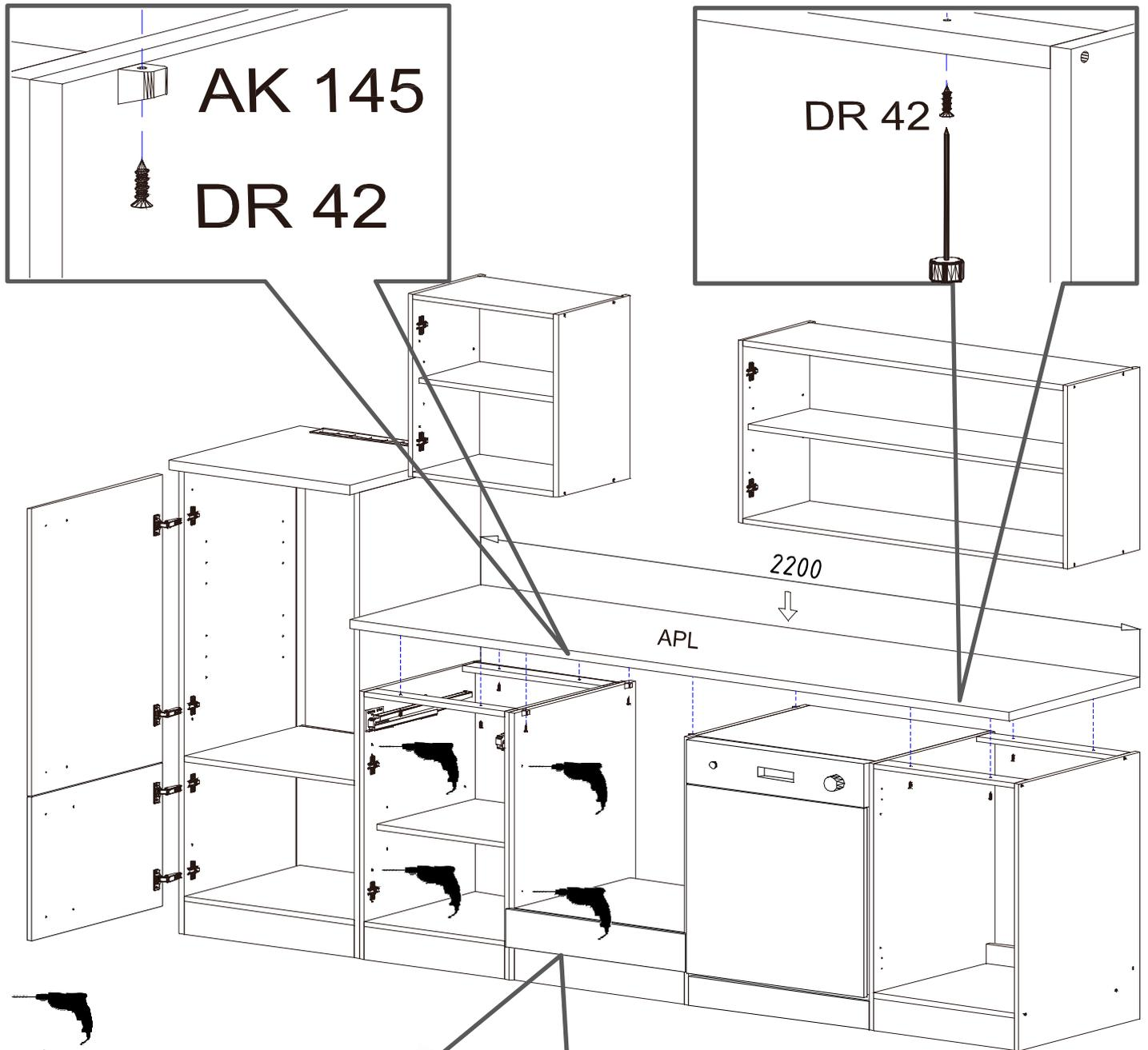
Mit  $\varnothing 5\text{mm}$  Bohrer durchbohren
