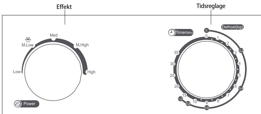
1. Vrid effektreglaget till önskad läge för att ställa in effektnivån.
