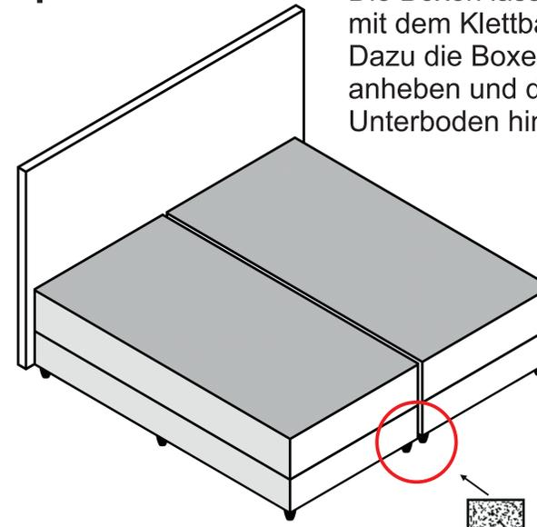
Die Boxen lassen sich am Fußende mit dem Klettband verbinden. Dazu die Boxen am Fußende leicht anheben und den Klettstreifen am Unterboden hinter den Füßen anbringen.
