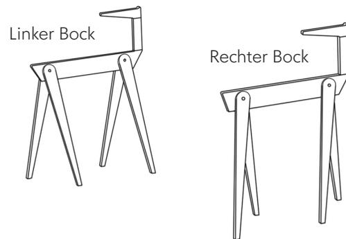
3. Verschrauben Sie die FüÙe mit den mitgelieferten Muffen und Schrauben. Stecken Sie die Puffer an die vorgegebenen Stellen. (blau markiert)
