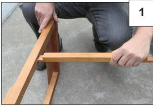
1 Zu Beginn verbinden Sie bitte die Frontseite (1) mit dem Unterkasten (2). Nutzen Sie hierzu die Verbindungsstreben (3) mit Nut und Feder.
