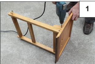
1 Die Fußbank lässt sich ganz einfach mit je 4 Schrauben (B) montieren.
