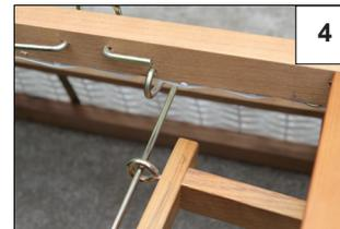
4 Das geschwungene Ende der Führungsschiene wird nun einfach hinten in die vorgebohrten Löcher gesteckt.
