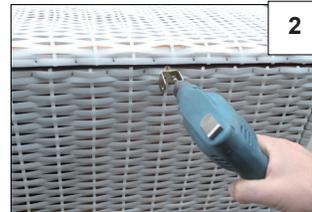
Zur Befestigung des Stützbügels an der Rückseite des Oberkorbs müssen Sie zunächst die U-Profile (H) mit je 2 Schrauben (C) an den markierten Stellen direkt unterhalb des Dachteiles montieren.
