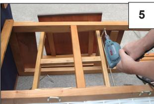
5 Am vorderen Teil des Unterkorbs wird jede Führungsschiene mittels einer Schraube (C) an der Leiste verschraubt.
