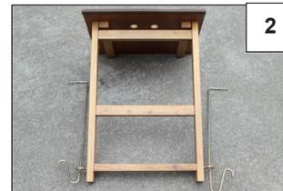
2 An der Fußbank sind hinten 2 Ringe für die Führungsschienen (F) angebracht. Die Schiene bitte so einführen, dass das geschwungene Ende hinten ist.
