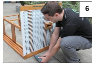
6 Montieren Sie jetzt die Seitenteile (5) mit 7 Schrauben (A) an die Basis. 2 Schrauben werden an dem Fußbrett und 5 an der Basiskonstruktion fixiert.
