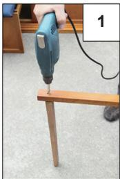
Zur Montage des Stützbügels (11) verbinden Sie bitte die drei Einzelstücke mittels 2 Schrauben (C).
