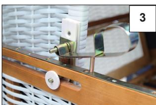
**3** Stecken Sie anschließend den Verstellgriff auf den oberen Bolzen und eine Kunststoffscheibe auf den unteren Bolzen.
