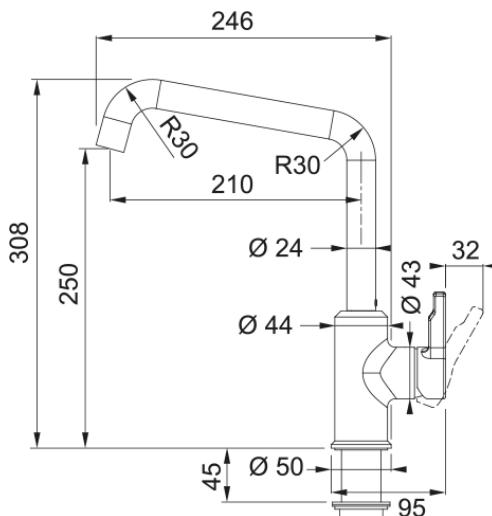
Urban Festauslauf, Steingrau, Hochdruck, Easy Installation, Schwenkbereich 150°, Hebel rechts, Schlauchlänge 45 cm
