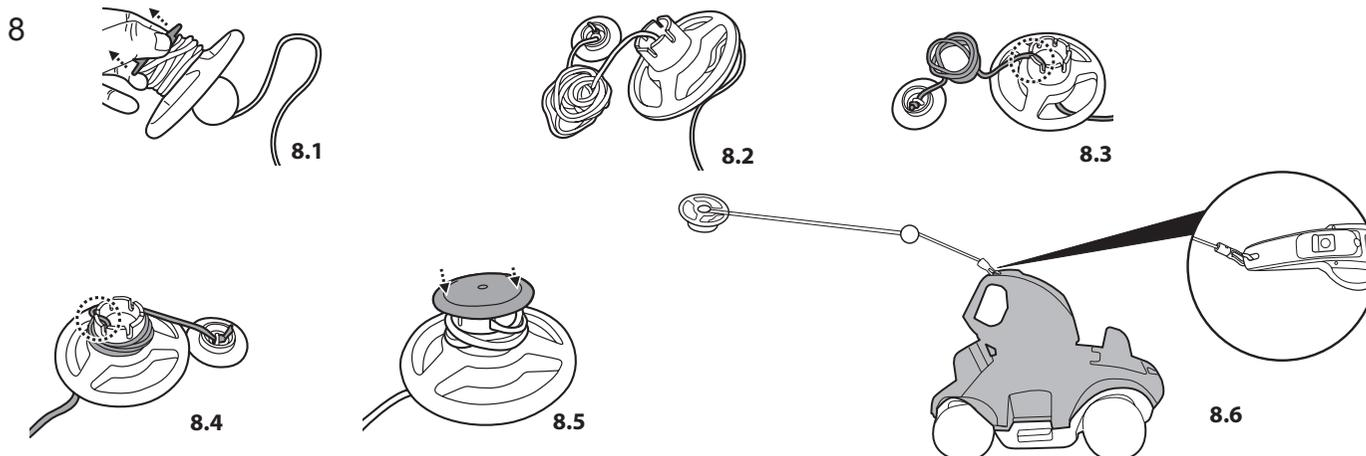
**Uwaga:** Podważyć, aby odłączyć pokrywę pływaką, zwolnić linę z pływaką do głębokości wody basenowej plus około 0,5 m (19,7”).
