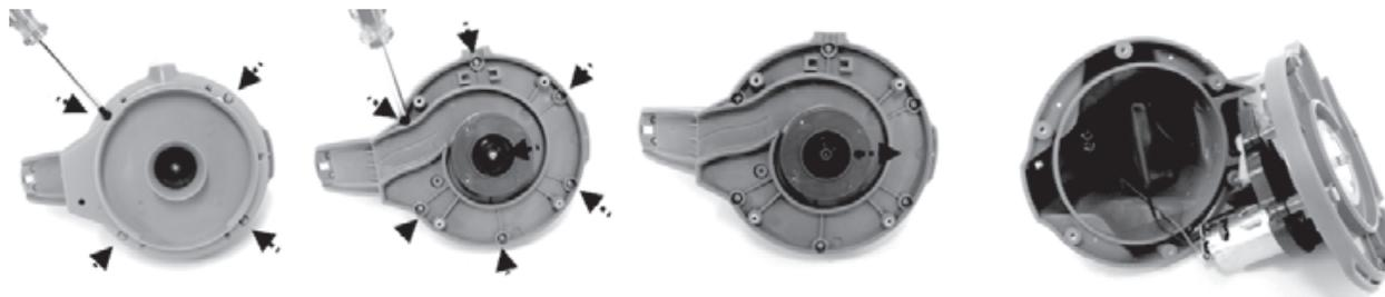
3. Nehmen Sie den Akkusatz heraus, um die Leiterplatte freizulegen. Um das Akkuanschlusskabel zu lösen, drücken Sie die Klammer am Steckverbinder und ziehen es heraus. **HINWEIS:** Wickeln Sie sofort Isolierband um den Steckverbinder, damit ein Kurzschluss infolge des Kontakts der beiden Drähte verhindert wird.
