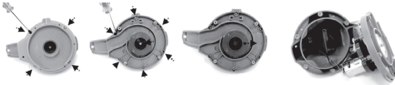
3. Estrarre la batteria per localizzare il circuito stampato. Scollegare il cavo batteria premendo sulla clip del connettore e tirando verso l'esterno. **NOTA:** Avvolgere i connettori con nastro isolante per evitare corti circuiti causati dal contatto tra entrambi i terminali.
