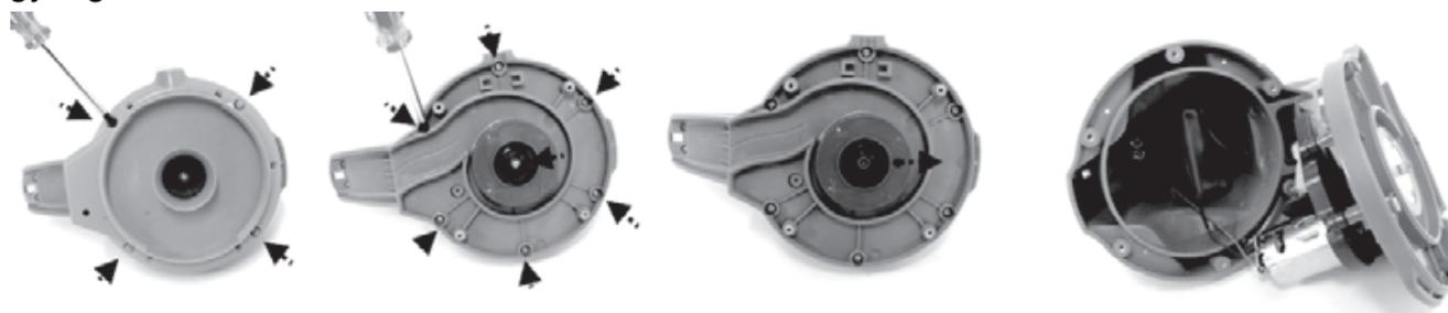
3. Távolítsa el az akkumulátorcsomagot a nyomtatott áramköri lap felfedéséhez. Az akkumulátor csatlakozókábelének a leválasztásához nyomja le a csatlakozón található kengyelt, és húzza ki a csatlakozót. **MEGJEGYZÉS:** A csatlakozót azonnal tekerje be szigetelőszalaggal, hogy megelőzze az egyéb kábelcsatlakozókkal való esetleges érintkezés okozta rövidzárlatot.
