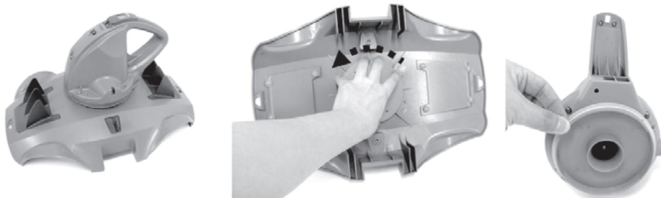
2. С помощью отвертки открутите 4 винта, расположенные на дне головки, чтобы снять сначала нижнюю пластину. С помощью отвертки открутите все винты на основании, как показано. Извлеките крыльчатку, а затем подденьте и снимите основание, чтобы открыть доступ к внутренней полости головки.
