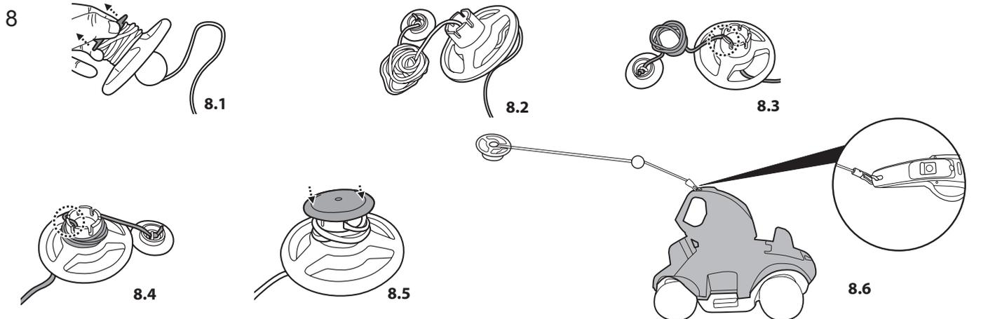
**Примечание.** Подденьте, чтобы отсоединить, крышку поплавка и отмотайте трос на длину, равную глубине воды в бассейне плюс около 0,5 м (19,7 дюйма).
