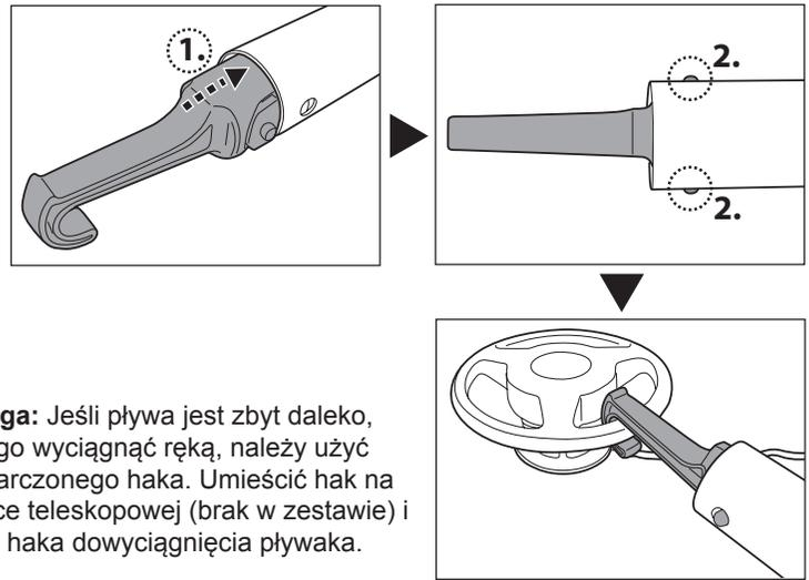
**Uwaga:** Jeśli pływa jest zbyt daleko, aby go wyciągnąć ręką, należy użyć dostarczonego haka. Umieścić hak na tycy teleskopowej (brak w zestawie) i użyć haka do wyciągnięcia pływaka.
