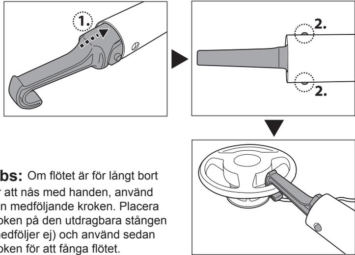
**Obs:** Om flötet är för långt bort för att nås med handen, använd den medföljande kroken. Placera kroken på den utdragbara stängen (medföljer ej) och använd sedan kroken för att fånga flötet.
