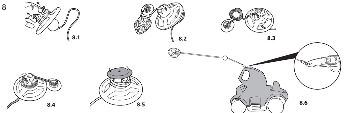
**Remarque :** Forcez pour détacher la bâche du flotteur et libérez la corde du flotteur à la profondeur de l'eau de la piscine plus environ 0,5 m (19,7 po.).
