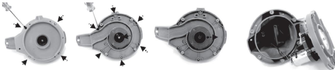
3. Retire el paquete de baterías para dejar a la vista el PCBA. Para soltar el cable de conexión de la batería, presione el clip del conector y luego tire de él hacia afuera.
