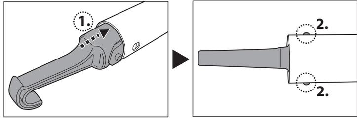
**Nota:** Si el flotador está demasiado lejos para alcanzarlo con la mano, utilice el gancho entregado. Coloque el gancho en el mango telescópico (no incluido) y luego utilice el gancho para recuperar el flotador.
