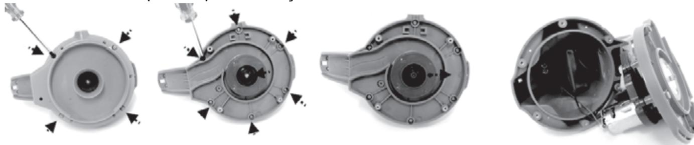
3. Remova a bateria para expor o PCBA. Para prender o cabo de ligação da bateria, prima o gancho no conector e puxe para fora. **NOTA:** Envolve o conector imediatamente com fita isoladora de forma a evitar curto-circuito provocado pelo contacto de ambos os terminais do fio.
