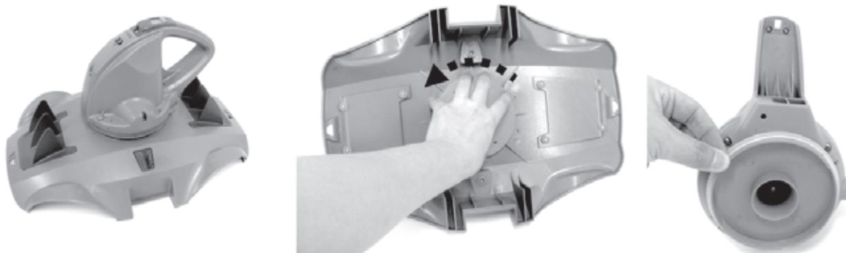
2. ΧΡΗΣΙΜΟΠΟΙΗΣΤΕ ΤΟ ΚΑΤΣΑΒΙΔΙ ΓΙΑ ΝΑ ΞΕΒΙΔΩΣΕΤΕ ΤΙΣ 4 ΒΙΔΕΣ ΠΟΥ ΒΡΙΣΚΟΝΤΑΙ ΣΤΟ ΚΑΤΩ ΜΕΡΟΣ ΤΗΣ ΚΕΦΑΛΗΣ ΩΣΤΕ ΝΑ ΑΠΕΛΕΥΘΕΡΩΣΕΤΕ ΠΡΩΤΑ ΤΗΝ ΠΛΑΚΑ ΤΗΣ ΒΑΣΗΣ. ΧΡΗΣΙΜΟΠΟΙΗΣΤΕ ΤΟ ΚΑΤΣΑΒΙΔΙ ΓΙΑ ΝΑ ΞΕΒΙΔΩΣΕΤΕ ΟΛΕΣ ΤΙΣ ΒΙΔΕΣ ΤΗΣ ΒΑΣΗΣ ΟΠΩΣ ΦΑΙΝΕΤΑΙ. ΑΦΑΙΡΕΣΤΕ ΤΗΝ ΦΤΕΡΩΤΗ ΚΑΙ ΣΤΗ ΣΥΝΕΧΕΙΑ ΞΕΒΙΔΩΣΤΕ ΤΗ ΒΑΣΗ ΚΑΙ ΑΦΑΙΡΕΣΤΕ ΤΗΝ ΩΣΤΕ ΝΑ ΑΠΟΚΑΛΥΦΘΕΙ Η ΚΕΦΑΛΗ ΠΟΥ ΕΙΝΑΙ ΜΕΣΑ.
