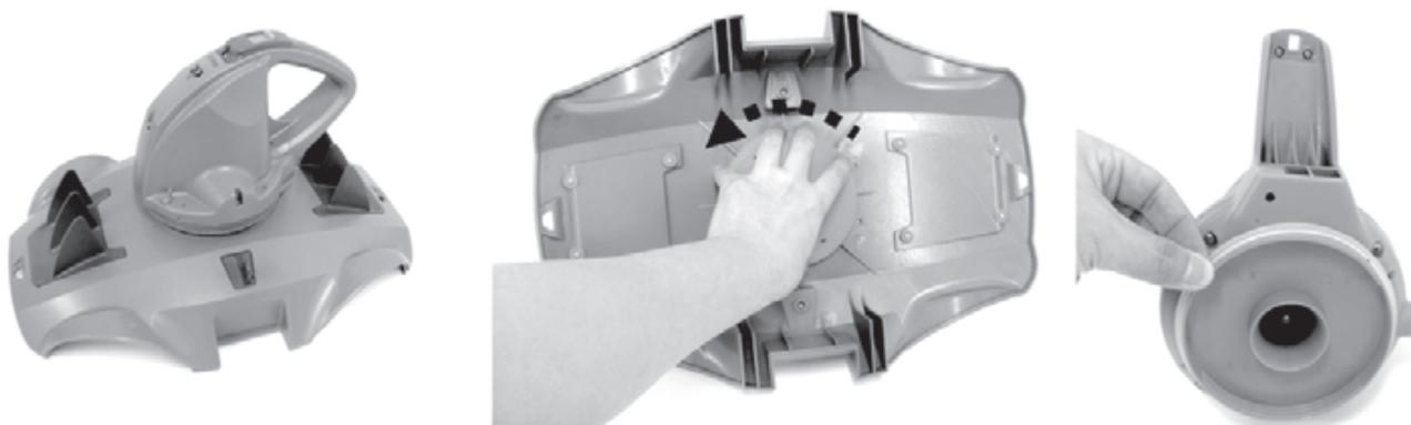
2. Użyć wkrętaka do odkręcenia 4 wkrętów znajdujących się w dolnej części głowicy, aby najpierw zwolnić płytę dolną. Użyć wkrętaka do odkręcenia wszystkich wkrętów podstawy, tak jak pokazano. Wymontować wirnik, a następnie podważyć podstawę i zdjąć ją, aby odsłonić wnętrze głowicy.
