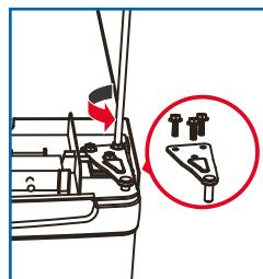
Lösen Sie zwei Schrauben an der Rückseite der oberen Abdeckung.
