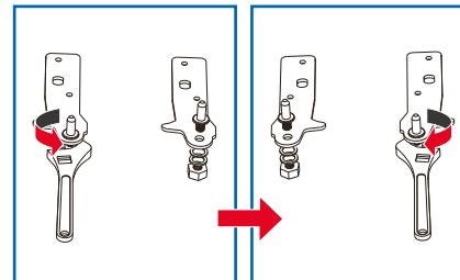
Demontieren Sie die unteren Scharniere & die Füsse.
