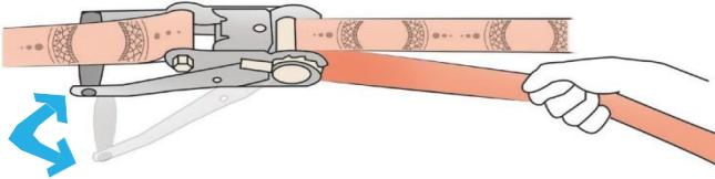
Halten Sie das Slackband fest und kurbeln Sie mit der Hebelstange auf und ab, um die Slackline zu spannen. Ziehen Sie nicht zu fest!
