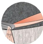
Um sicherzustellen, dass das Gurtband unter Druck flach und gespannt bleibt, falten Sie das Gurtband v-förmig und zwar dort, wo das Gurtband mit der schwarzen Schlinge in
