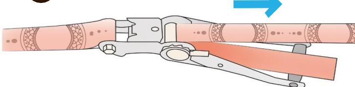
Um die Slackline zu lösen, ziehen Sie den Entriegelungsheber um die Ratsche zu entsperren. Halten Sie die Hebelstange gut fest und drücken Sie diese auf, bis sich die Spannung der Slackline löst. Halten Sie Ihre Finger von der Ratsche fern, da durch das Lösen der Spannung eine enorme Kraft entsteht.
