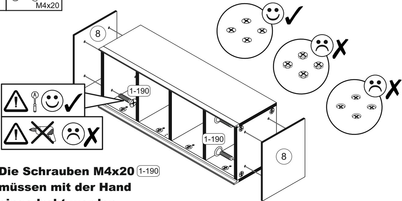
**Die Schrauben M4x20 (1-190) müssen mit der Hand eingedreht werden.**
