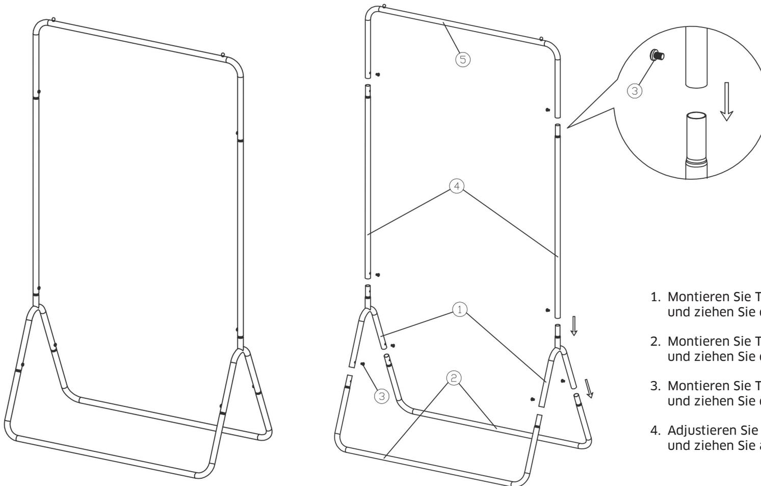
1. Montieren Sie Teile 1 in Teile 2 und ziehen Sie diese ein wenig mit den Schrauben Nr. 3 an.
