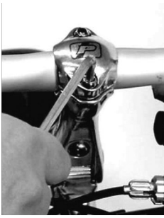
Einstellung des Lenkerbügels mit einem Inbusschlüssel
