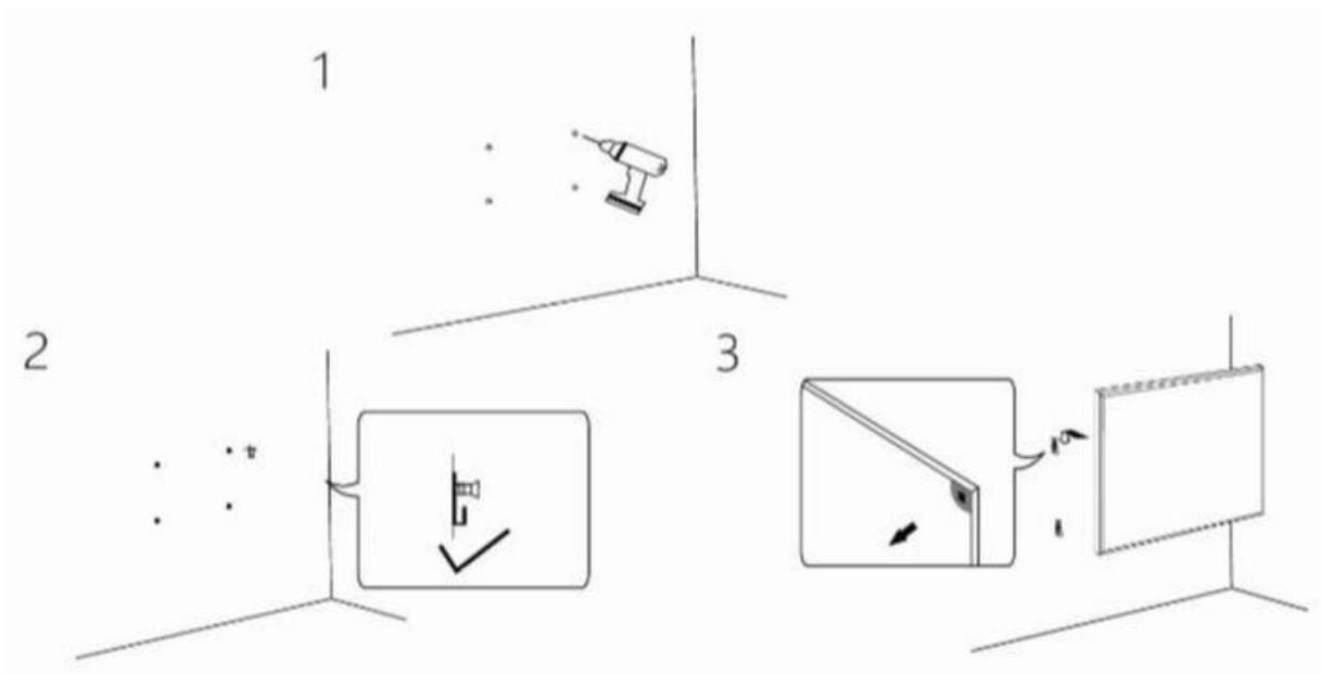
1. Messen Sie von der Infrarotheizplatte die Abstände der Aufhängungspunkte.
