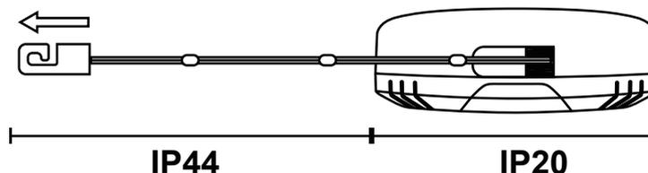
**DE:** Im ausgerollten Zustand entspricht nur die Lichtkette der Schutzart IP44, das Gehäuse entspricht IP20. Im ausgerollten Zustand das Gehäuse vor Wasser schützen.
