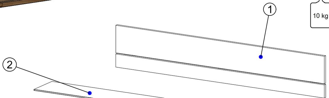
Achtung! Lösen Sie die markierten Schrauben, um die Montage von Element 2 zu erleichtern.
