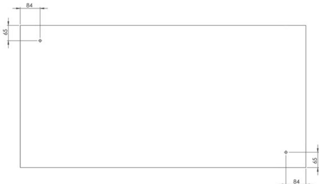
Markieren Sie die benötigten Befestigungspunkte auf der Unterseite der Arbeitsplatte (AP).
