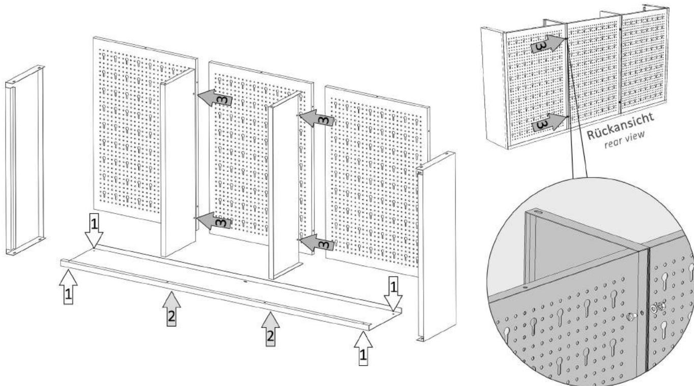
Schrauben Sie die beiden Seitenwände (2) links und rechts an den Boden (3), wobei außen die Schrauben und innen die Muttern und Unterlegscheiben sitzen. Setzen Sie jetzt die beiden Mittelwände (4) wie in der Abbildung gezeigt ein und schrauben Sie diese ebenfalls an das Bodenteil. Platzieren Sie die Rückwände (1) wie abgebildet im Aufbau. Achten Sie darauf, dass die Rückwände richtig herum und mit der Aussparung nach hinten gerichtet sind! Verschrauben Sie die Rückwände nun mit den Mittelwänden.
