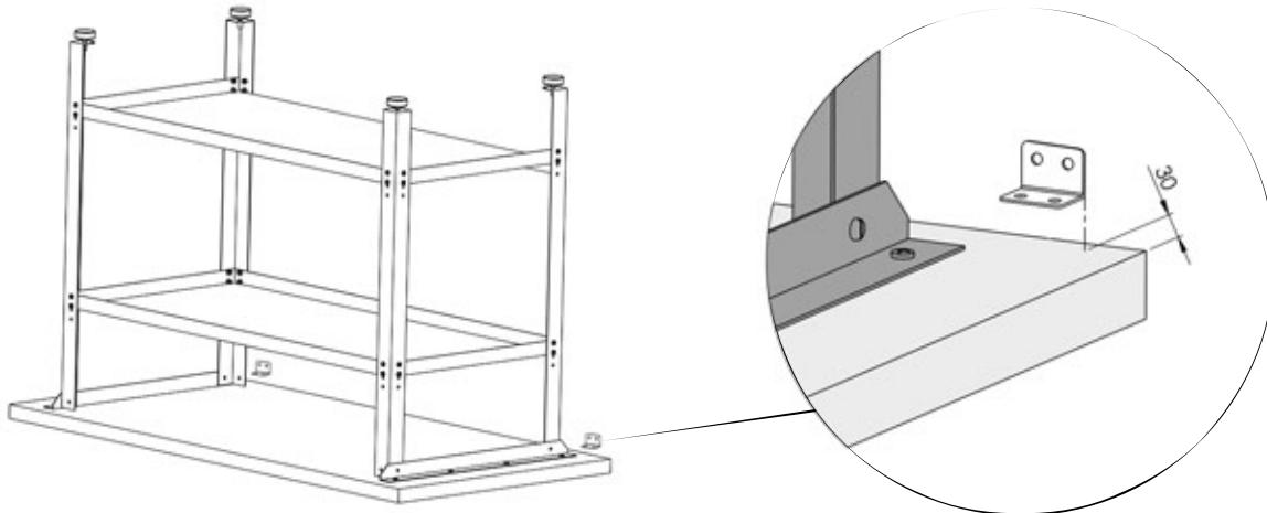
Schrauben Sie die beiden Anbauwinkel (N7) mit Hilfe von jeweils zwei Schneidschrauben (9) mit einem Abstand von 30 mm zu den Ecken auf der Rückseite der Arbeitsplatte. Stellen Sie die Werkbank wieder auf.
