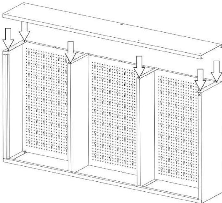
Schrauben Sie jetzt den Deckel (3) auf die Konstruktion. Verschrauben Sie die Mittelwände (4) nun auch mit dem Deckel.
