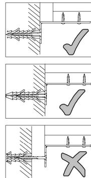
Upozornění! Před montáží je nutné zkontrolovat stav stěny. Přiložené hmoždinky jsou určeny pouze k použití pro pevné zdi jako beton/cihly. Hmoždinky do zdi se nesmí používat u dutinové cihly, zdí jako písčový stavební kámen, sádrokartónová deska nebo jiný měkký materiál. U těchto zdí jsou nutné použít speciální hmoždinky! Jsou k dostání v prodejnách se stavebním materiálem. Při nedodržení těchto pokynů výrobce/prodejce a dovozce neručí za způsobené škody.
