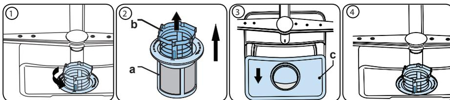
Drehen Sie die Filterkombination zum Entfernen und Reinigen gegen den Uhrzeigersinn und nehmen Sie sie durch Anheben nach oben heraus **(1)**. Ziehen Sie den Grobfilter aus dem Mikrofilter heraus **(2)**. Ziehen Sie dann den Metallfilter **(3)** heraus und entfernen Sie ihn. Spülen Sie den Filter mit viel Wasser ab, bis er frei von Rückständen ist. Bauen Sie die Filter wieder zusammen. Setzen Sie den Filtereinsatz wieder ein und arretieren Sie ihn im Uhrzeigersinn **(4)**.
