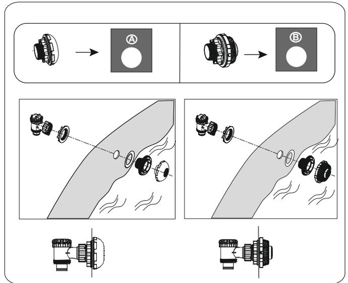
**HINWEIS:** Wenn Sie ein Poolreinigungsset über das Anschlussventil anschließen möchten, dann schrauben Sie das Schmutzsieb ab.
