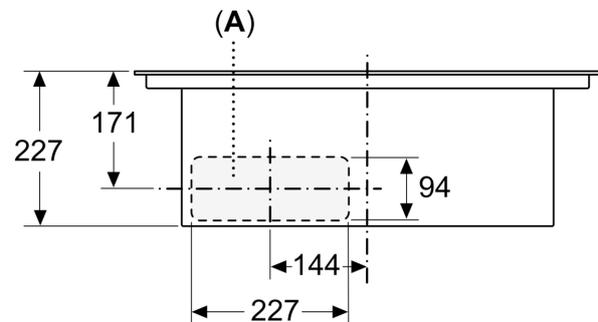
**A: Direkt an der Rückseite angeschlossen**
