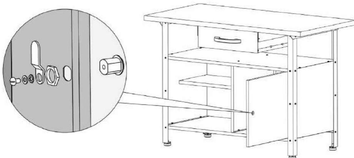
Stecken Sie den Schließzylinder des Schlosses (L) durch die in der Tür vorgesehene Öffnung und fixieren Sie ihn wie in der Abbildung. Prüfen Sie vorher, ob die Schließrichtung korrekt ist.
