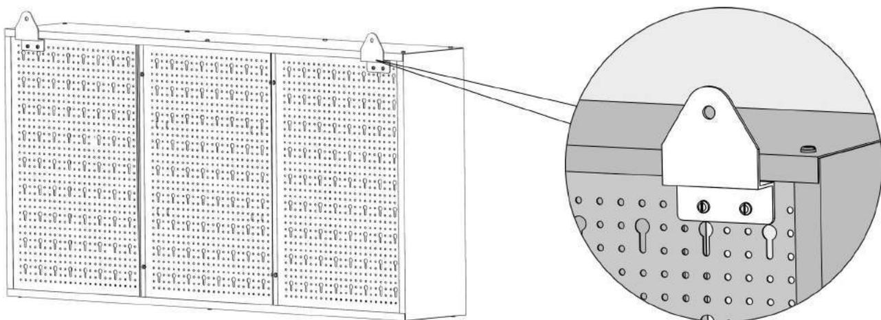
Befestigen Sie die beiden Aufhängungen (7) wie abgebildet mit je zwei Schraubensets links und rechts an der Rückwand.
