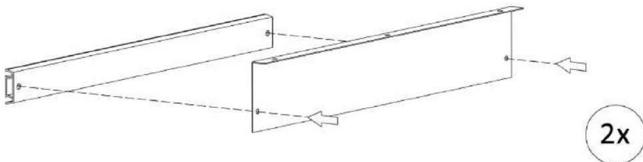
Schrauben Sie je eine Schubladenaufhängung (K9) mit einer Schubladenführung (S4) auf der kantenlosen Seite zusammen.
