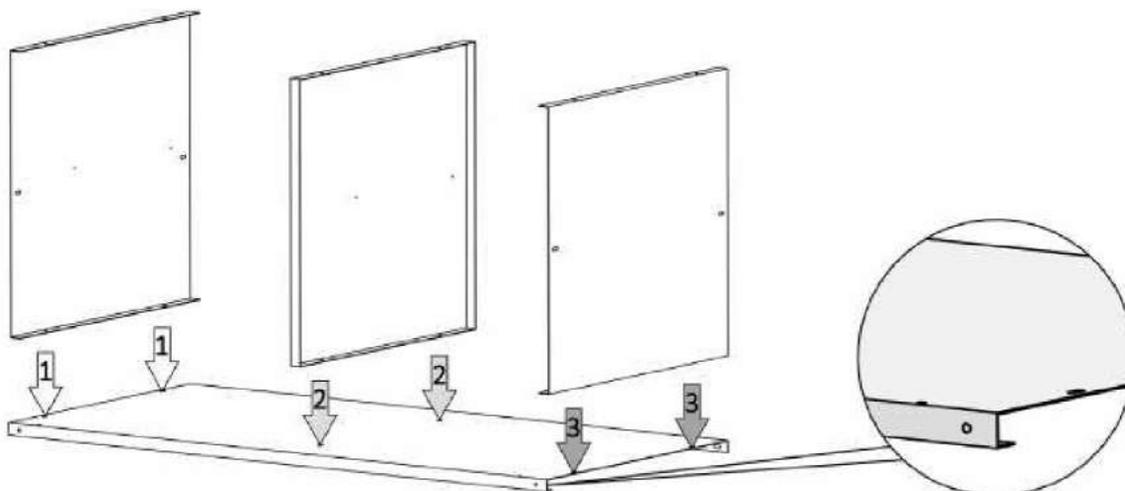
Schrauben Sie mit Hilfe von sechs Schraubensets (23) die Seitenwand 1 (K4), die Mittelwand (K7) und die Seitenwand 2 (K5) an den Boden (K3). Achten Sie darauf, dass der Boden mit den Kanten nach unten ausgerichtet ist!
