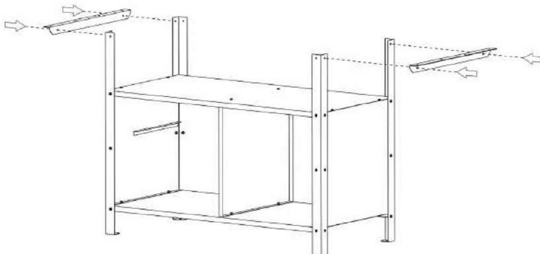
Befestigen Sie die beiden Verbindungswinkel (K2) wie abgebildet mit je zwei Schraubensets (23) an den Tischbeinen auf der linken sowie rechten Seite der Werkstattbank.
