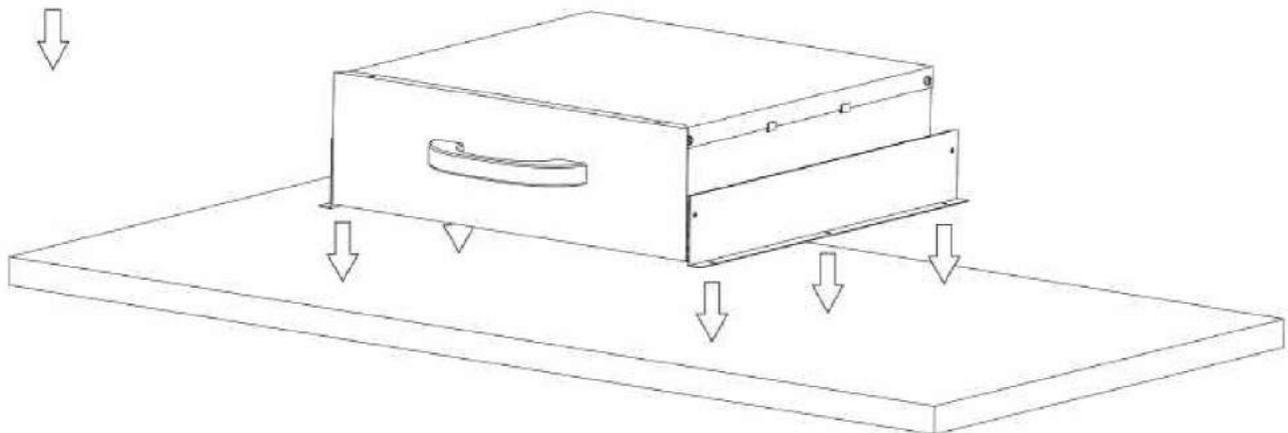
Schrauben Sie die Schubladen-Konstruktion mit Hilfe von sechs Schneidschrauben (25) auf die inneren Markierungen der Unterseite der Arbeitsplatte (10).
