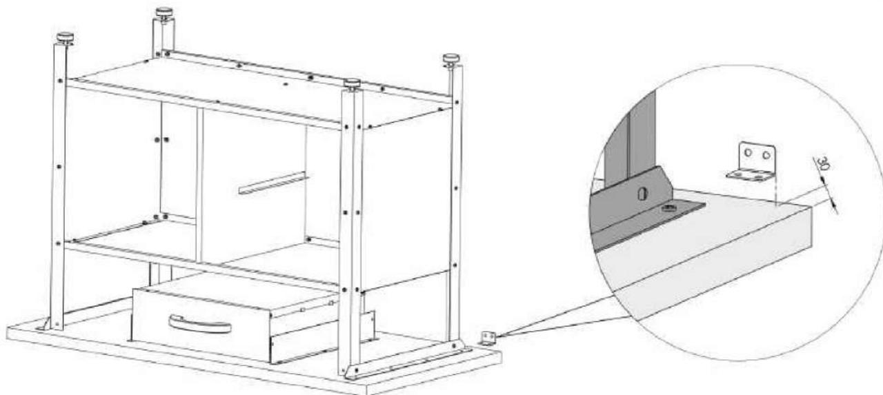
Schrauben Sie die beiden Anbauwinkel (AW) mit Hilfe von jeweils zwei Schneidschrauben (25) mit einem Abstand von 30 mm zu den Ecken auf der Rückseite der Arbeitsplatte. Stellen Sie die Werkbank wieder auf.
