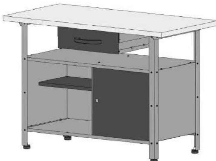
Ziehen Sie zum Schluss noch einmal alle Schrauben kräftig nach. Schrauben Sie die Werkbank an die Wand. Vergewissern Sie sich vor der Wandmontage, ob die gewählten Schrauben und Dübel für Ihre Wand geeignet sind.
