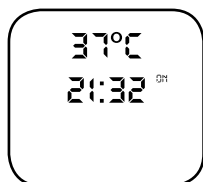
Vorheizen „AN / ON“
