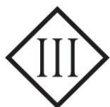
Schutzklasse III. Keine Sicherheitsverbindung zur elektrischen Erde
