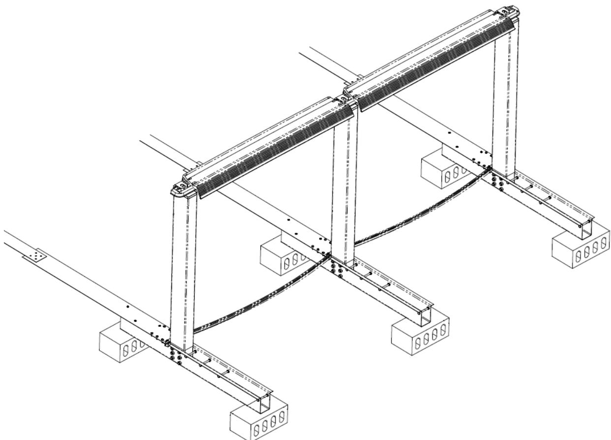
**Überprüfen Sie genau den Abstand zwischen allen Stützpfeuern (Maß S im Kapitel 7.1) und deren senkrechte Ausrichtung. Es muss ebenfalls überprüft werden, dass es zwischen den einzelnen Pfeuern keine Höhenunterschiede gibt.**
