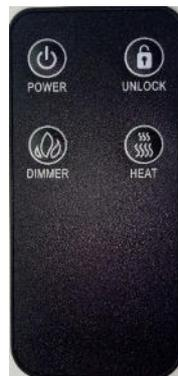
Die mitgelieferte Fernbedienung hat entgegen der in der Anleitung abgebildeten dieses Aussehen und ist zusätzlich mit einer Entsperr-Funktion „UNLOCK“ ausgestattet. Durch Drücken dieser Taste
