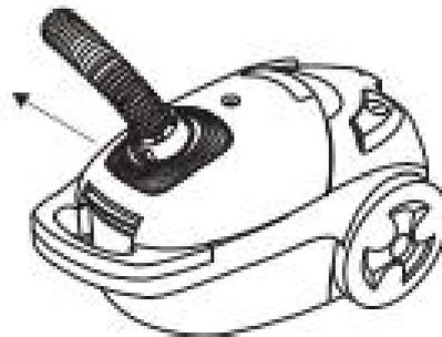
(3) Stecken Sie wie abgebildet das obere Ende des Teleskoprohrs in den Griff und das untere Ende in die Bodendüse.
