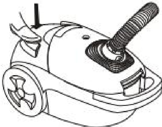
(2) Po použití lze zařízení odstavit podle obrázku.
