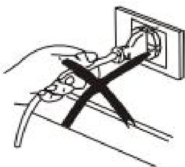
2. Ne laissez pas l'appareil passer sur le câble d'alimentation pendant l'utilisation.
