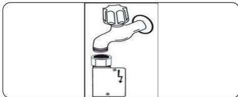
**⚡** Un système anti-débordement Aquastop est utilisé dans certains modèles. Ne l'endommagez pas et ne le laissez pas être endommagé ou tordu.
