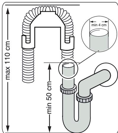
Raccordez le tuyau d'évacuation de l'eau directement à un trou d'évacuation de l'eau ou au siphon d'évacuation d'un évier. Ce raccordement doit être au minimum à 50 cm et au maximum à 110 cm du sol sur lequel est placé le lave-vaisselle.
