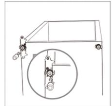
7. Entfernen Sie die Türdichtung des Gefrierschranks. Drehen Sie die Dichtung um 180° und bringen Sie sie wieder an.
