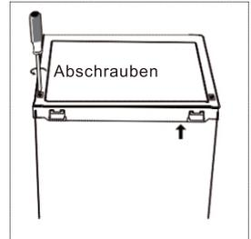
2. Entfernen Sie die obere Abdeckung und den Thermostatregler; legen Sie beide Teile beiseite.
