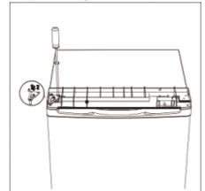
9. Bringen Sie die obere Abdeckung an und sichern Sie diese mit den 2 Schrauben an der Rückseite.
