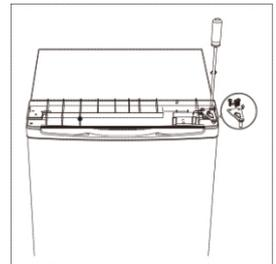
4. Schrauben Sie das untere Scharnier ab. Entfernen Sie dann die verstellbaren Füße an beiden Seiten.
