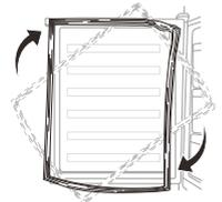
8. Installieren Sie dann wieder die Tür. Vergewissern Sie sich vor dem Festziehen des oberen Scharniers, dass die Tür horizontal und vertikal so ausgerichtet ist, dass die Dichtungen an allen Seiten gut verschlossen sind.
