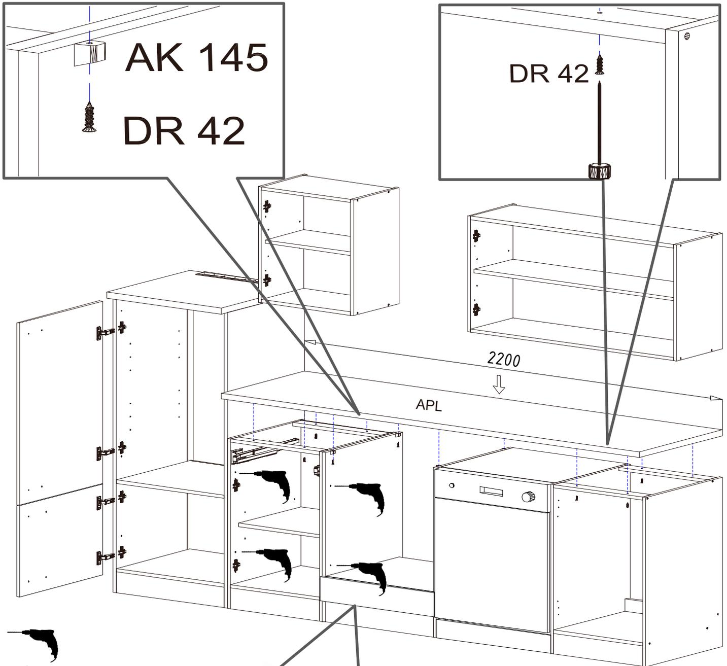
Mit Ø5mm Bohrer durchbohren
