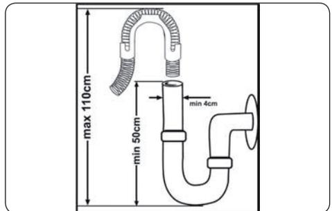
Ablaufschlauch direkt an den Abfluss anschließen. Anschlussstelle muss sich in einer Höhe zwischen 50 cm und 110 cm über dem Boden befinden.
