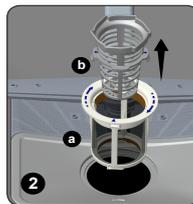
herauszunehmen und zu reinigen, müssen Sie sie entgegengesetzt zum Uhrzeigersinn (nach links) drehen und dann herausnehmen. **1**
