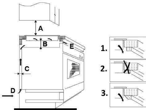
**D = BELÜFTUNGSSCHLITZ / E = LUFTAUSSLASS**
