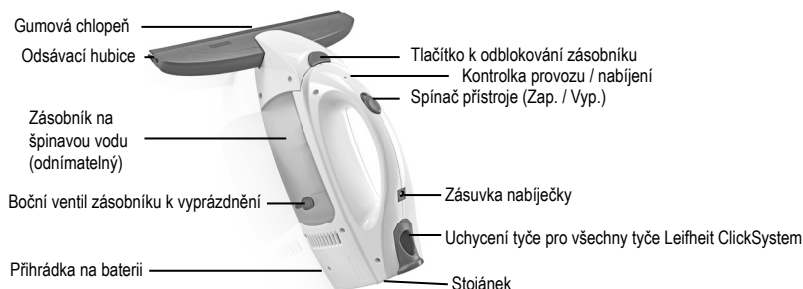
Obrázek 2: Obslužné prvky okenní odsávačky
