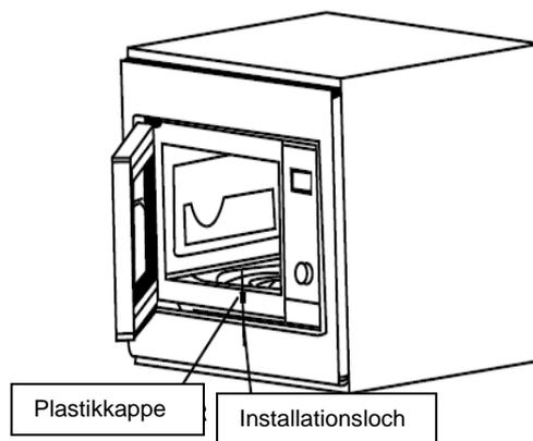
2. Öffnen Sie die Tür und fixieren das Gehäuse indem Sie die Schraube B in das Installationsloch von den Einbausatz schrauben und anschließend bringen Sie die Plastikkappe des Einbausatzes an.
