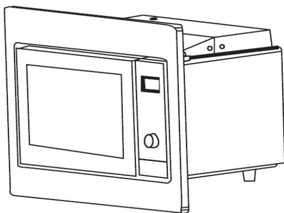
Der Einbauschränk darf keine Rückwand haben. Minimale Installationshöhe ist 85 cm. Lüftungsschlitze und Lufteinlass nicht abdecken.
