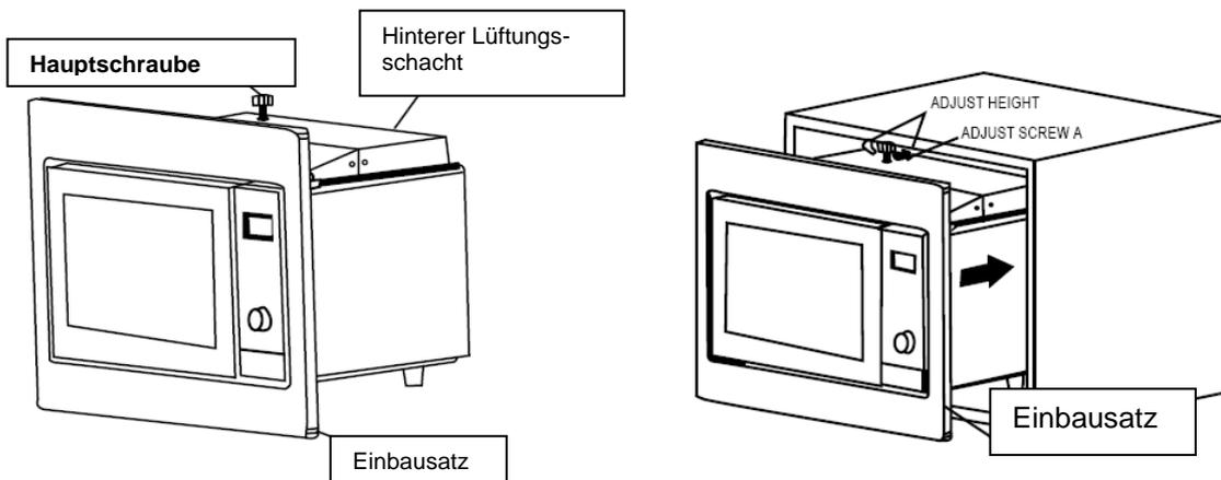
2. Fixieren Sie die Haupt-Schraube und anschließend installieren Sie die Mikrowelle
