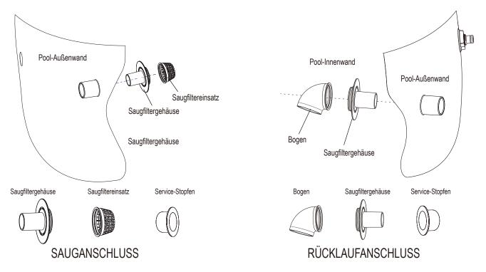
Beachten Sie: Die schwarze Gummidichtung (Verbindungsdichtung) muss immer auf die Kunststoffsaug- oder Rückschlagverbindung aufgebracht werden und sich bereits im Inneren befinden, bevor die Verbindung durch die Beckenwand geschoben wird. Nur so ist eine wasserdichte Verbindung möglich.
