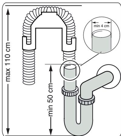
Collega il tubo di scarico dell'acqua direttamente al foro di scarico dell'acqua o al rubinetto del lavandino. Questo collegamento deve essere di almeno 50 cm e massimo 110 cm dal pavimento su cui è posizionata la lavastoviglie.
