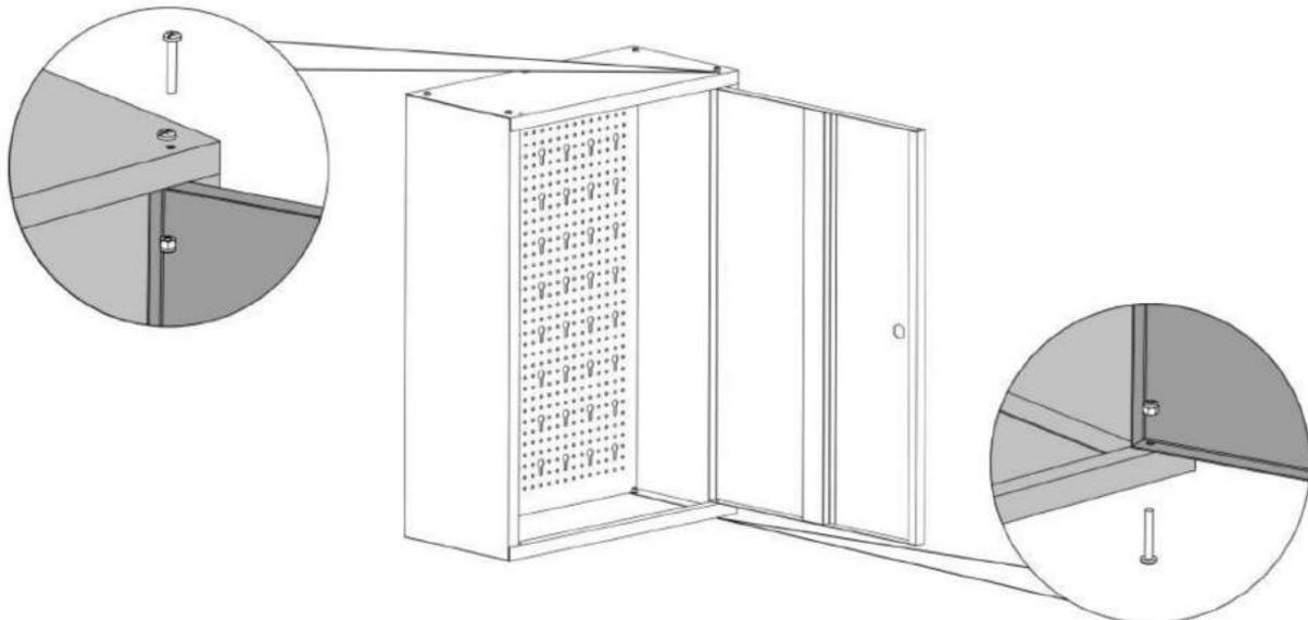
Verschrauben Sie die Tür oben und unten mit dem Deckel und Boden. Die Schraubenköpfe sitzen außen, die Stopmuttern innen.
