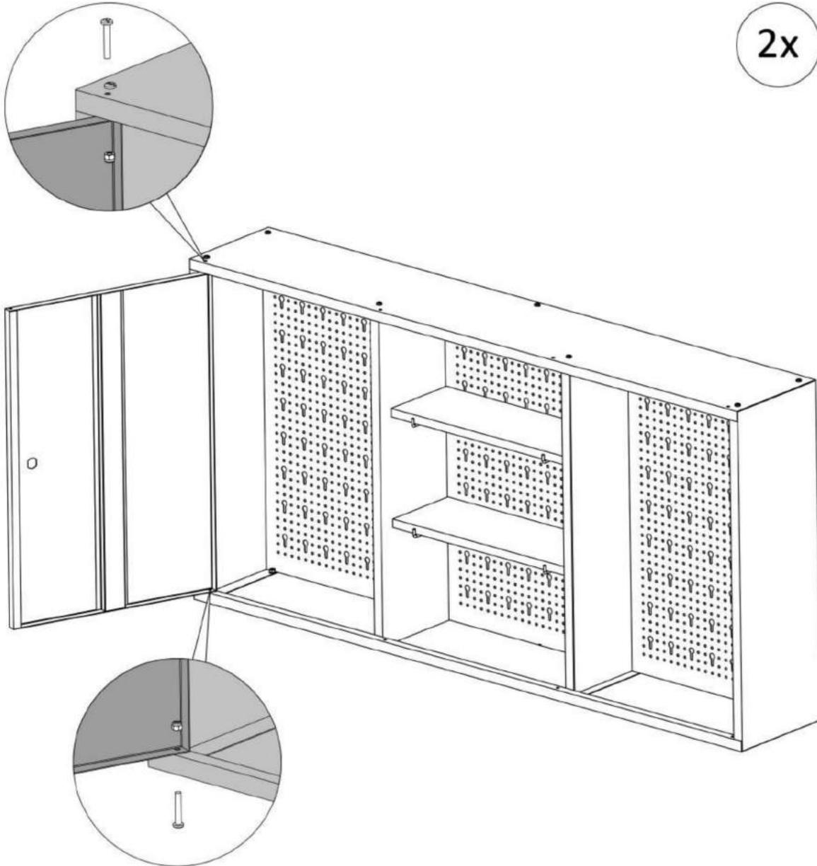
Verschrauben Sie die Tür oben und unten mit dem Deckel und Boden. Die Schraubenköpfe sitzen außen, die Stopmuttern innen.
