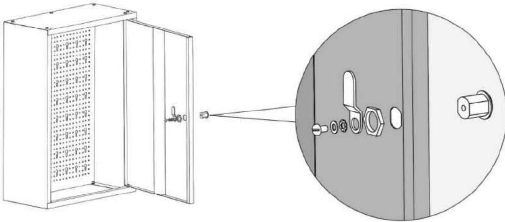
Stecken Sie den Schließzylinder durch die in der Tür vorgesehene Öffnung und fixieren Sie ihn wie in der Abbildung. Prüfen Sie vorher, ob die Schließrichtung korrekt ist.
