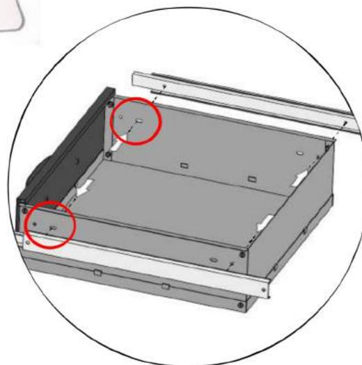
Schrauben Sie die Schublade mithilfe des Schraubensets M5x6 (24) wie dargestellt an die bereits installierten Schubladenschiene.
