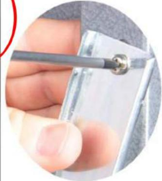
Schrauben Sie die Schubladenschiene (S4) wie dargestellt mit je 2 Schraubensets M5x8 (23) an die Seitenwand 1 und die Seitenwand 2 an. Wiederholen Sie Schritt 1 für jede Schublade. Die Anzahl der Schubladen Ihrer Werkbank können Sie der Stückliste auf Seite 5 entnehmen. **ACHTUNG:** Die Schraubenköpfe müssen in Richtung der Schubladenschiene zeigen.
