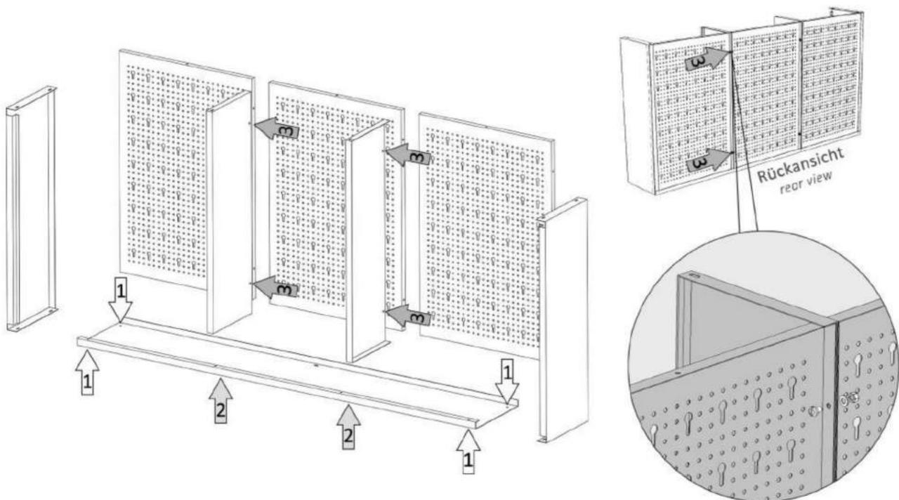
Schrauben Sie die beiden Seitenwände (2) links und rechts an den Boden (3), wobei außen die Schrauben und innen die Mutter und Unterlegscheiben sitzen. Setzen Sie jetzt die beiden Mittelwände (4) wie in der Abbildung gezeigt ein und schrauben Sie diese ebenfalls an das Bodenteil. Platzieren Sie die Rückwände (1) wie abgebildet im Aufbau. Achten Sie darauf, dass die Rückwände richtig herum und mit der Aussparung nach hinten gerichtet sind! Verschrauben Sie die Rückwände nun mit den Mittelwänden.
