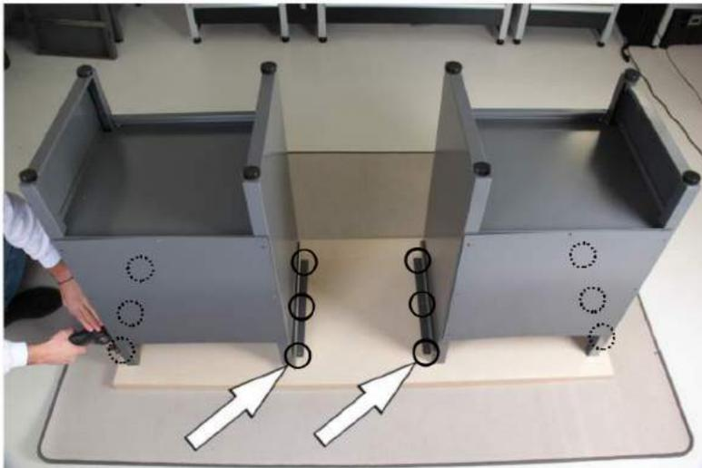
Richten Sie die Unterbauten an den gekennzeichneten Stellen (Schritt 5) auf der Arbeitsplatte (AP) wie abgebildet aus und verschrauben Sie die Korpusse mit der Arbeitsplatte. Kippen Sie die Werkbank mit einer 2. Person und stellen Sie sie auf die Justierfüße. Positionieren Sie die Werkbank an der in Ihrem Raum vorgesehenen Stelle.
