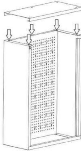
Schrauben Sie jetzt das Oberteil (1) auf die Konstruktion. Verschrauben Sie die Rückwand (3) nun auch mittig mit dem Deckel (1).
