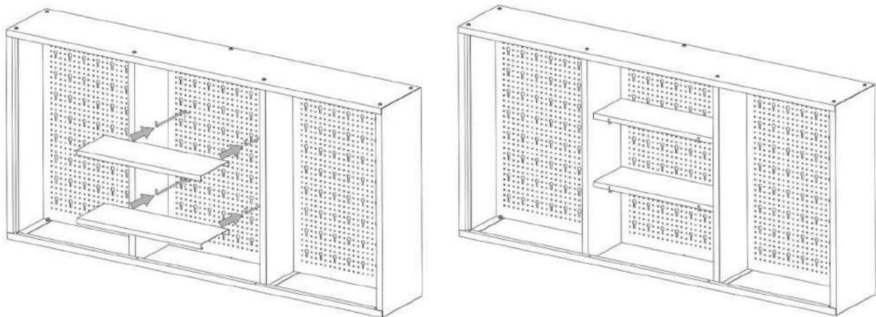
Stecken Sie nun die vier Halterungen für die Einlegeböden (5) in die Rückwände. Legen Sie die Einlegeböden (5) dann auf die Halterungen.
